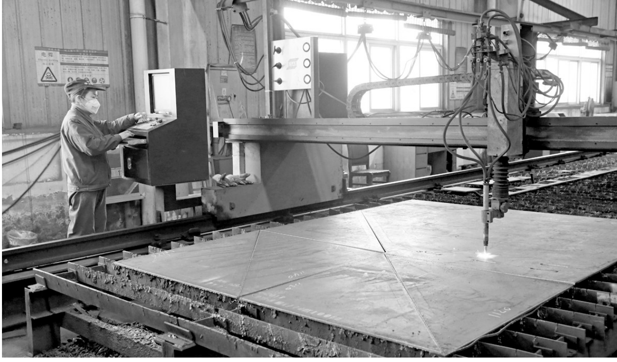
铜冠机械公司备件制造分厂员工正在操控数控火焰切割机下料。该分厂自开年以来紧扣生产目标，在调配好人员、设备、原材料的基础上，积极开展劳动竞赛活动，掀起大干热潮，全力推进在产项目按时按质完工。
