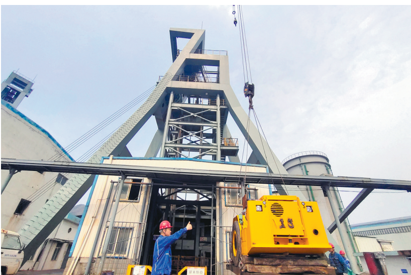
3月15日,铜山铜矿分公司采矿车间成功将一台新铲运机吊装至井下负433米中段,为满足矿山下一步生产需要提供设备保障。这个公司在打造本质安全型企业的同时,以科技补短板,大力推广应用新装备、新技术、新工艺,在高危岗位推进“机械化换人、自动化减人”,将好钢用在“刀刃”上,减轻职工劳动强度,提高生产效率。 张霞 汪新民 摄
