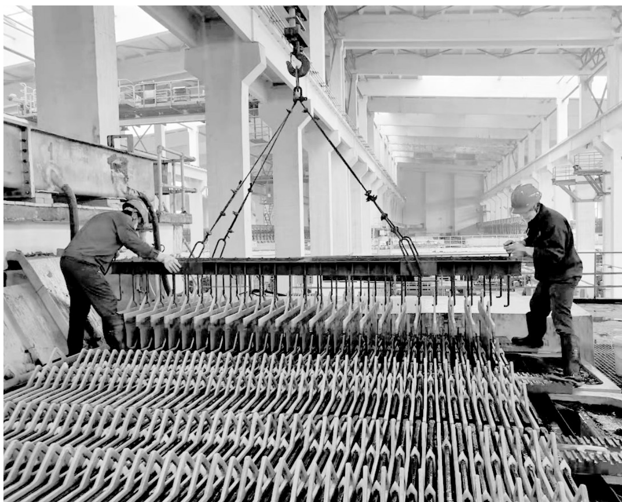
铜冠池州公司锌分厂1月份锌产品产量超计划229吨,析出锌直流电平均单耗同比下降4.45%,用突出业绩践行公司年终工作会议要求,实现首战开门红。图为员工正在进行装出槽作业。 霍建军 摄
