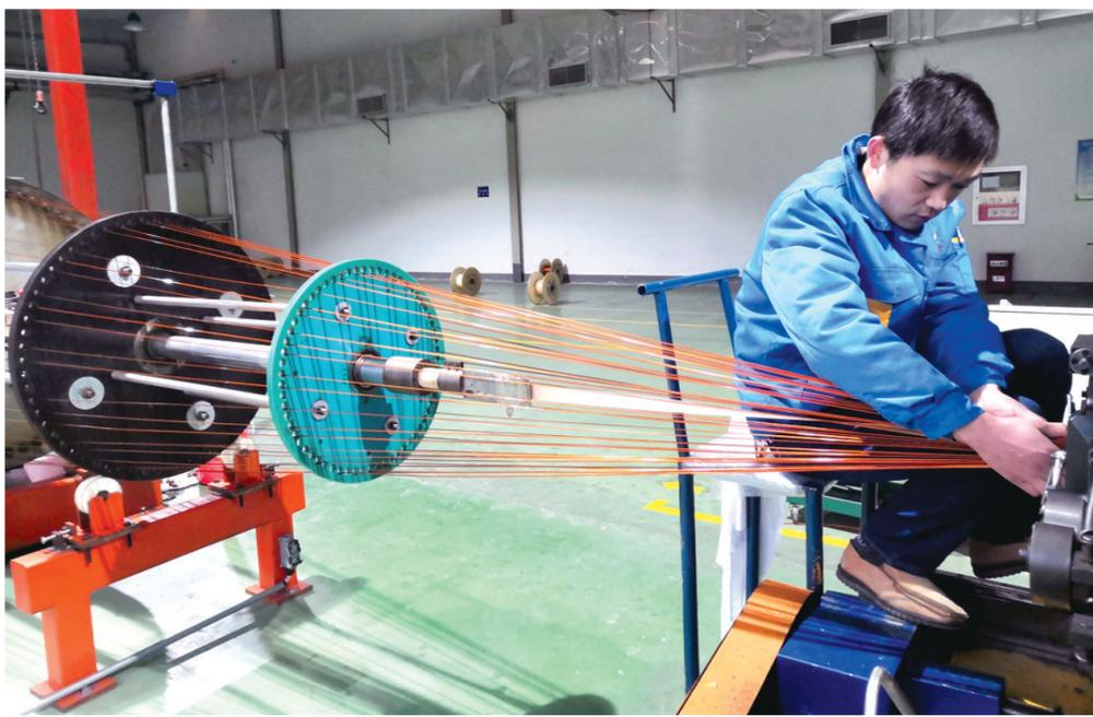
日前,铜冠铜箔公司换位线工场为满足客户需求,加强技改,有效杜绝了5平方毫米规格以下的换位导线产品容易出现散开和子绝缘漆膜破损的质量问题。图为该工场员工正在生产该规格的产品。
