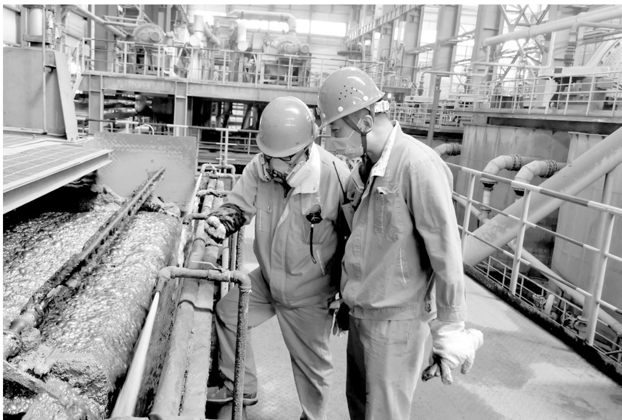
铜冠(庐江)矿业公司强化产品质量过程管控。1月19日,选矿车间浮选工通过现场观察铜精矿泡沫状况(如图),判断铜精矿品位,并根据结果及时调整优化生产参数,以保证铜精矿产品合格达标。萨百灵 王树辰 摄
