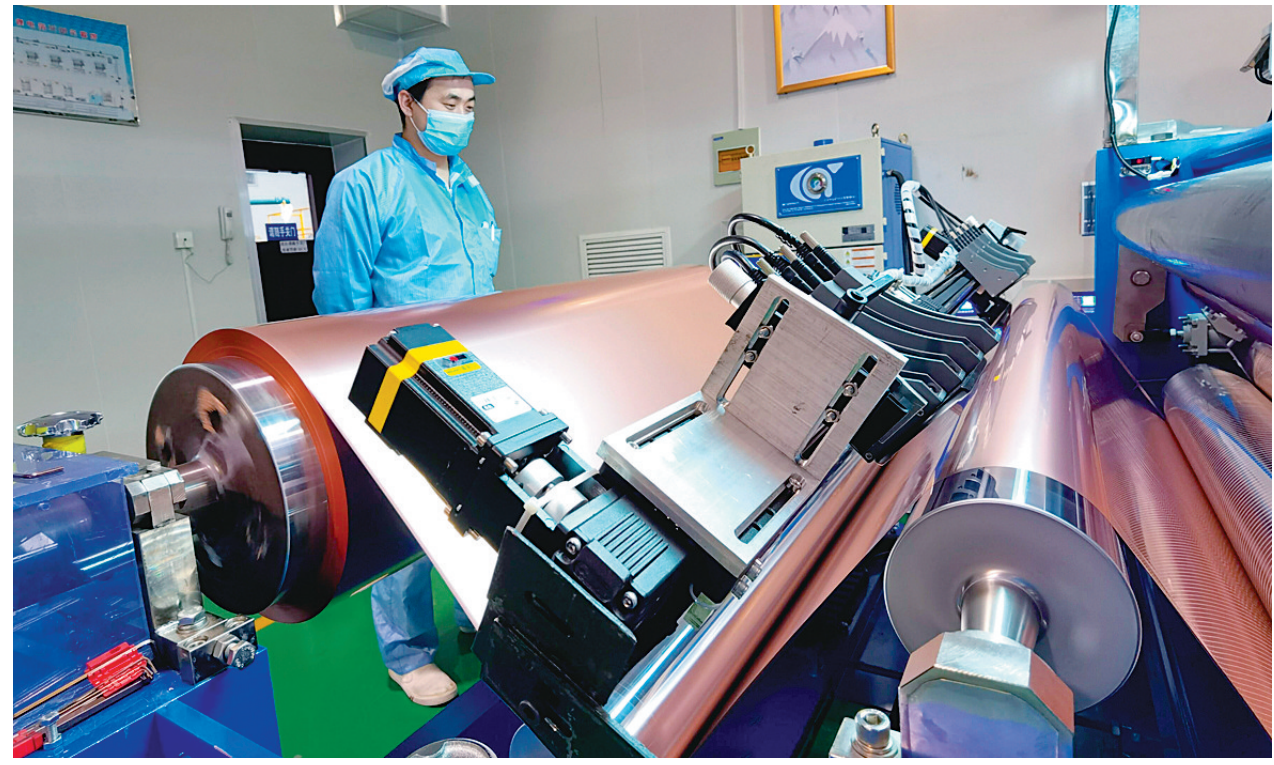
日前,铜冠铜箔公司五六工场对分切机加装喷码机。加装喷码机之后,到来数之后自动喷码开机,较大幅度提高了喷码精确度和人工效率。图为现场人员正在观察喷码机使用情况。
