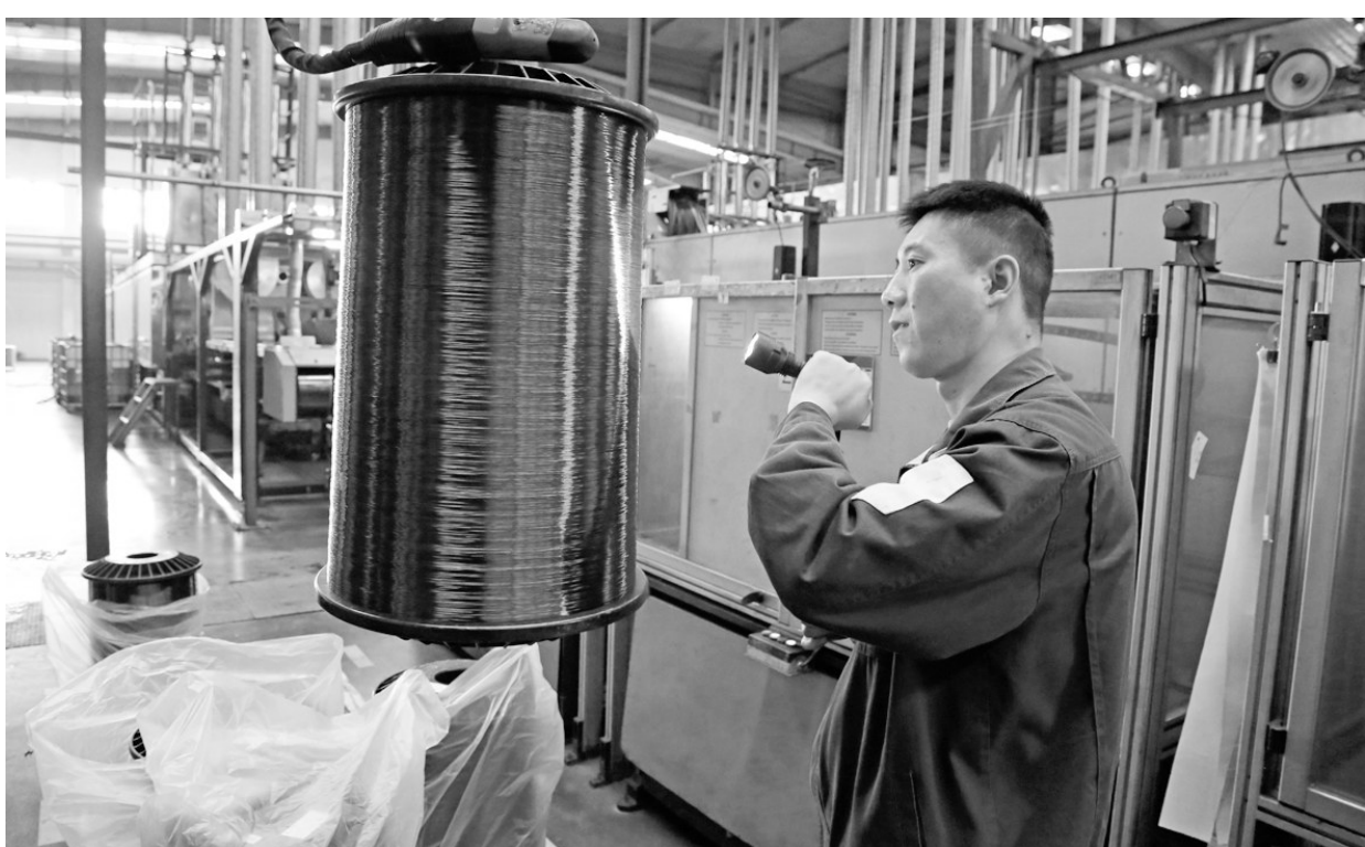
铜冠电工公司员工正在生产铝漆包线。该公司针对市场上铝漆包线替代铜漆包线趋势越来越快,在抓好铜漆包线生产的同时,积极加大铝漆包线生产,不断提高铝线产能。
