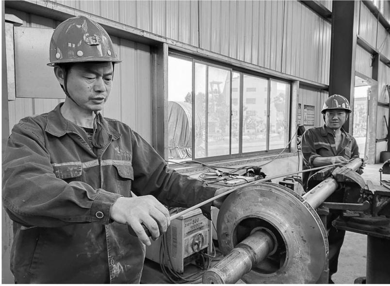
铜山铜矿分公司在决战四季度生产过程中,以设备“零故障”管理为目标,从加强设备现场管理、加大设备调剂和计划性维修入手,及时排除设备故障,为冲刺四季度安全生产筑牢设备基础。图为该公司维修人员在装配井下排水泵轴承,为井下设备的正常使用提供安全保障。 张霞 摄
