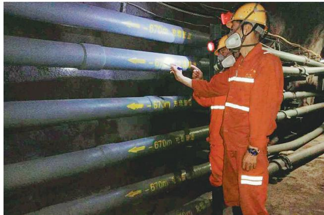
冬瓜山铜矿随着井下充填管线向深部中段延伸,需要班组职工熟练掌握每一处新调整或新移装管线对应采场及钻孔位置事项,如若稍有差错就会出现误操作不安全现象。为此,该矿充填区班组职工摸索出“线上”充填法,即对防腐一新的充填管线,每隔一段距离用排刷蘸满油漆在管壁上工工整整地写下管线编号、连接采场等信息(如图),让各班既能“在线”获悉每一套充填管的真实“身份”,同时也为日渐频繁的充填管线拆移、吊装作业,能够一次性“对号入座”完成管道移装作业。
