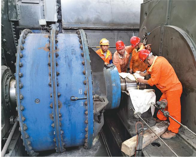
日前,铜冠(庐江)矿业公司选矿车间维修人员正在检查球磨机主电机轴承瓦套磨损情况(如图),通过对磨损面的仔细检查,发现有异常问题再及时处理。
