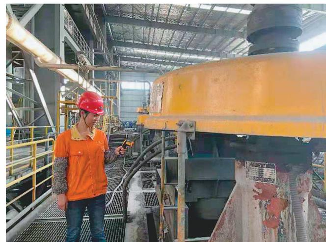
日前,铜冠(庐江)矿业公司选矿车间浮选工正在进行浮选机日常巡检。浮选工用红外测温仪测量浮选机轴承温度,判断浮选机工况是否正常,便于及时发现故障及时处理,确保设备正常运转。 孔艳珍 撰
