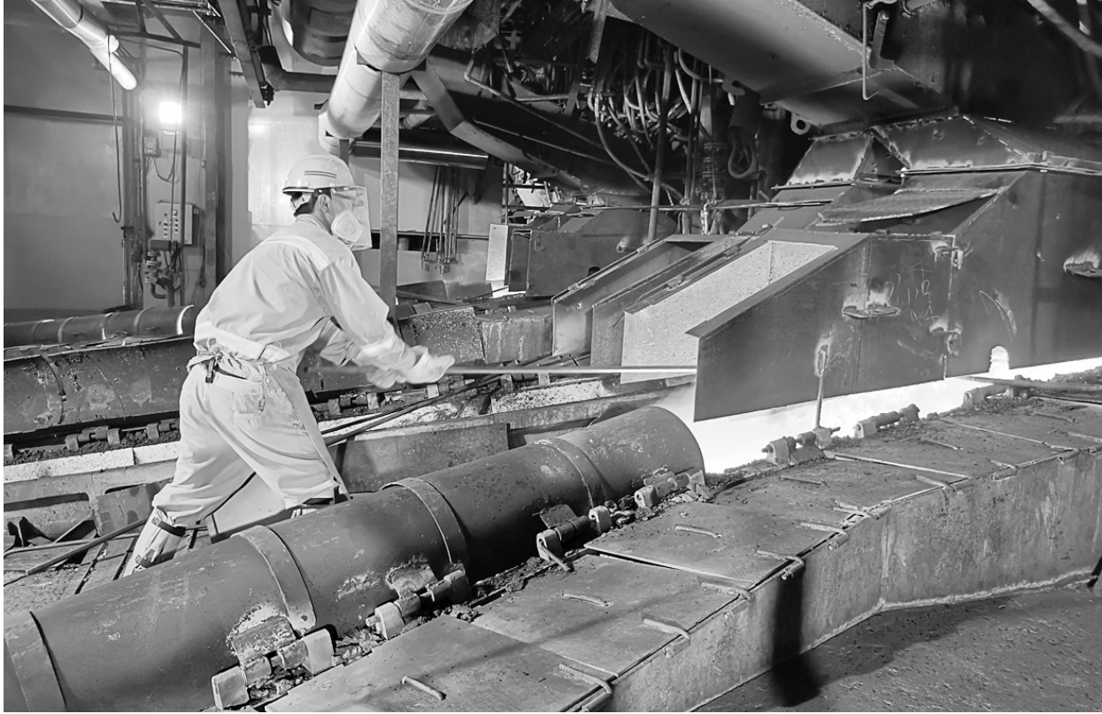
金冠铜业分公司双闪冶炼车间从年初开始制定一系列管理提升措施,狠抓两台闪速炉质量管理,促进车间安全稳定绿色发展。三季度首月首次实现了两台闪速炉系统作业率同时大于99.2%,创造了自试生产以来的历史最好成绩。图为闪速熔炼炉渣口操作人员正在进行排渣作业。 陈幸欣 吕俊 摄
