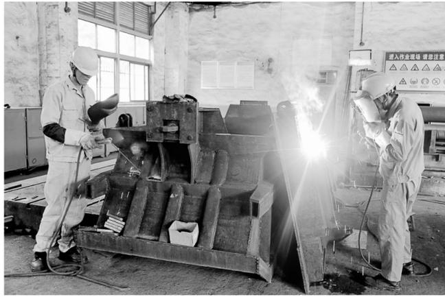
近年来,安庆铜矿在职工中积极弘扬工匠精神,通过技能培训、业务考核、多方面提供实战条件及适当奖励等,激发了职工学技术、钻技术和解决实际难题的工作热情。图为该矿机修厂维修人员正在制作适合井下深部使用的重型矿车。 杨勤华 摄
