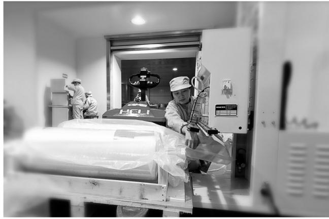
为防止铜箔氧化,延长铜箔保存期限,日前铜冠铜箔公司五六工场分切工段顶住生产压力,积极研究真空包装,确保产品质量。图为该工段分切工正在对产品进行真空包装。 纪小坤 摄
