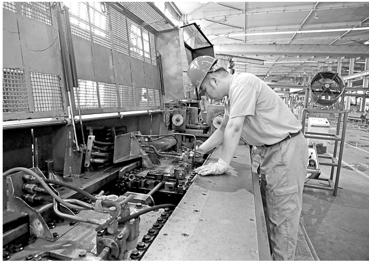
铜冠黄铜公司员工正在生产中做好设备清洁(如图)。铜冠黄铜公司在深入开展5S精益管理活动中,认真开展每周一次设备检查,月度考核,同时根据现场实际情况,在各工序设立标杆,进行整体或分片实施。通过清扫、清洁后,设备的故障率明显降低,现场的跑冒滴漏有效减少。王红平 汪勇 摄
