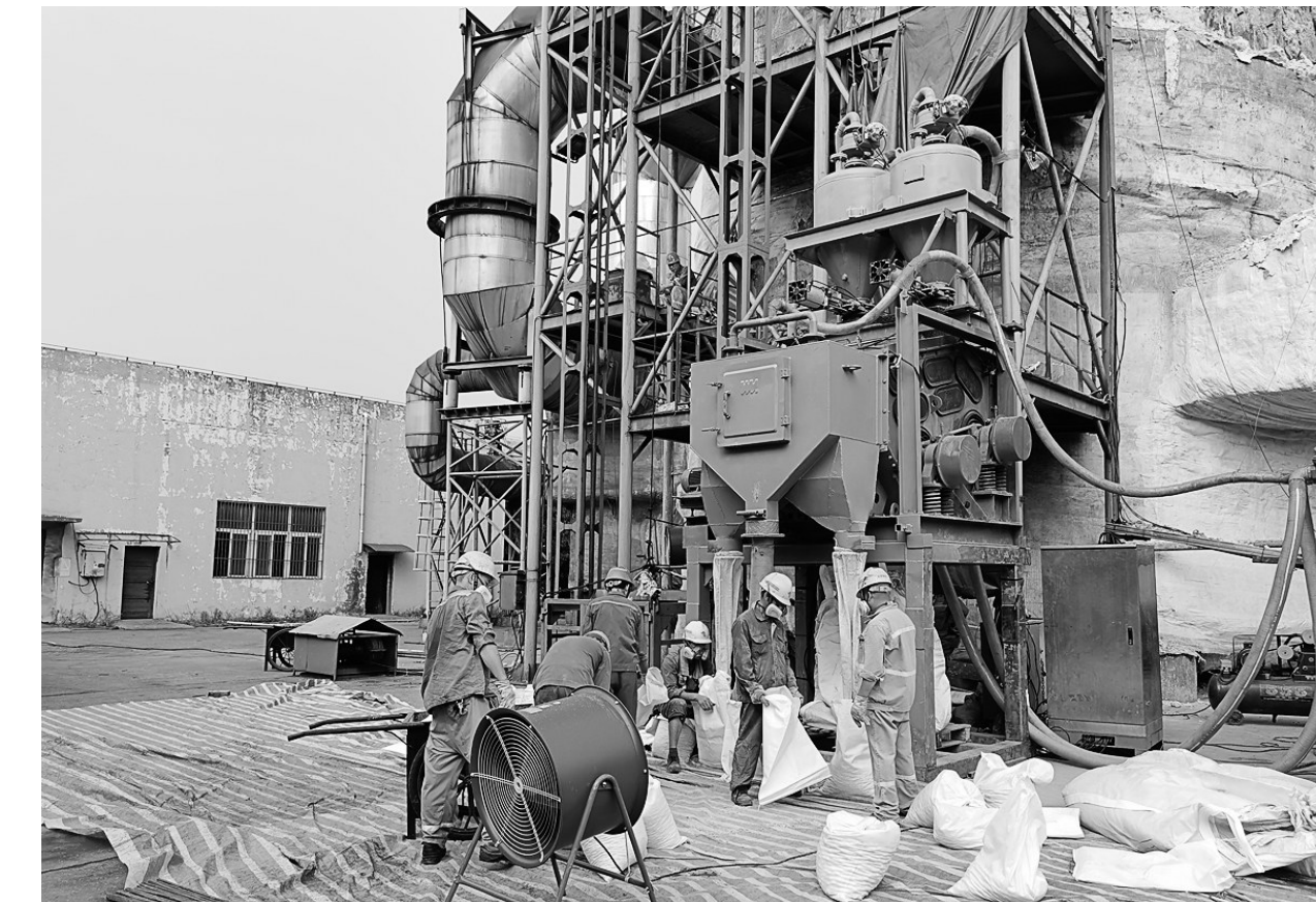
9月1日,铜冠池州资源公司组织人员对硫酸一期转化器触媒进行筛分。该公司为抓住硫酸价格回升的市场机遇,对硫酸一期生产系统进行计划性停车检修,集中处理设备工艺累积问题和隐患,确保四季度生产高效平稳运行,向全年生产目标发起冲刺。 夏富青 蔡英健 摄
