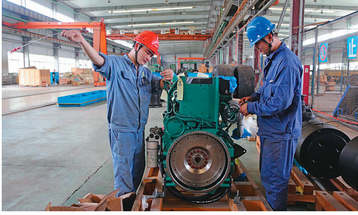
铜冠机械公司员工正在验收检测到货的发动机。铜冠机械公司在提高无轨设备质量中,一方面狠抓无轨设备的制作装配质量,一方面严把外购发动机的品质,并对进厂发动机及时做好检验检测验收工作。
