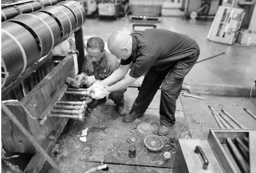
铜冠电工公司设备维修人员正在精心检修漆包线生产机器。该公司在设备检修工作中,严格执行设备检修工艺规程和技术标准,检修作业做到“探到位、敲到位、看到位、修到位”,重点盯控设备关键部件,实行签章记名修,强化责任,提高检修效率,保证检修质量,确保设备有效运转。 王红平 华伟 摄
