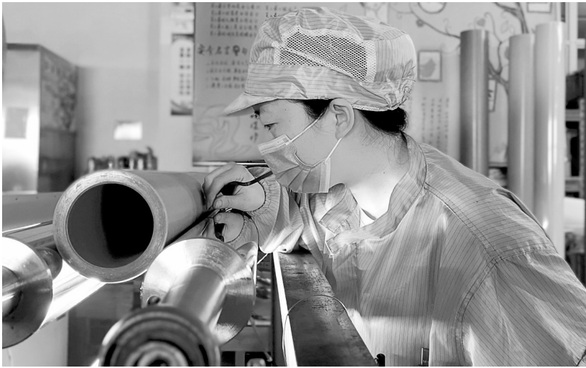
为满足客户需求,杜绝因辅材原因造成的产品质量问题,日前,合肥铜箔公司全面加强辅材管理,严把验收入库关,加大对纸管等重要辅材的质量验收管理,为铜箔产品的安全、有效生产提供更加可靠的质量保证。图为该公司分切工段正在用塞尺检验纸管直线度。 吴云霞 摄
