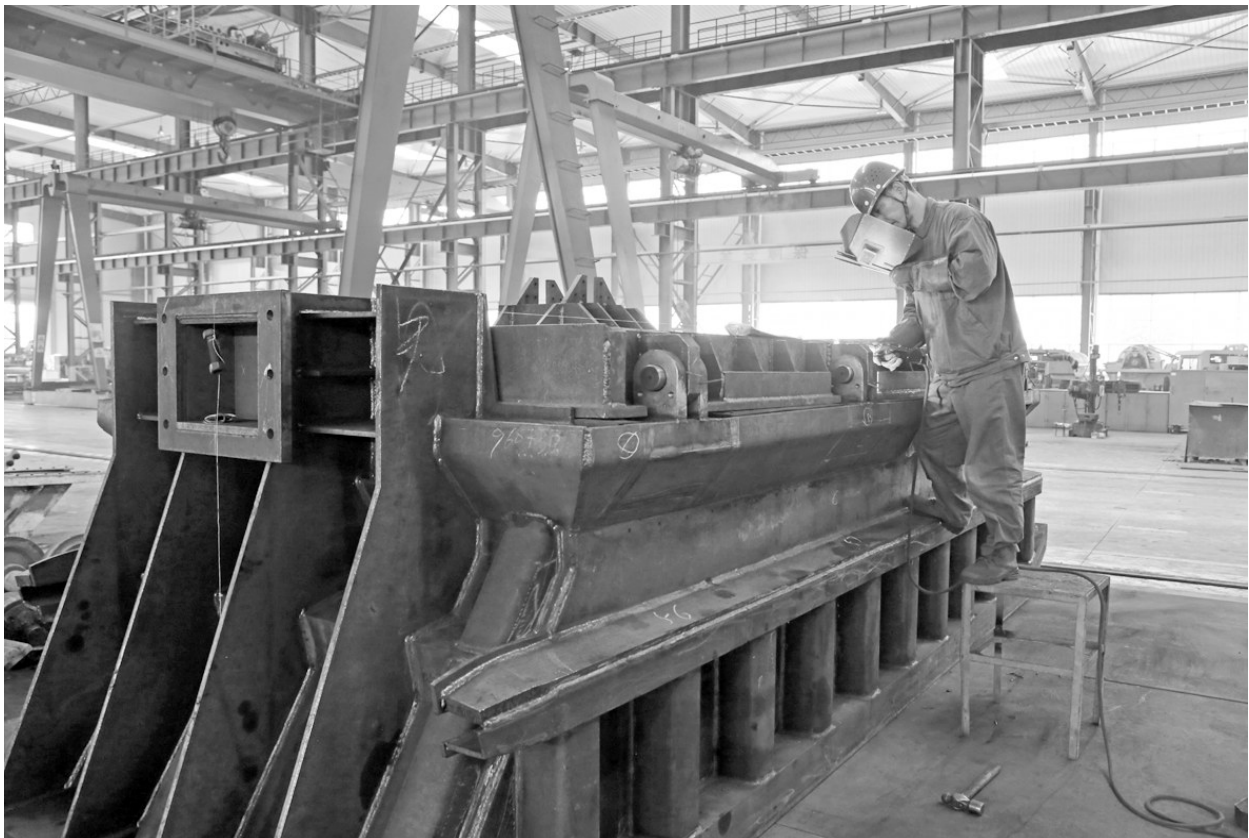
铜冠机械公司装配分厂员工正在焊接矿车。铜冠机械公司装配分厂于6月上旬承接了10台10立方米矿车组装的急活,通过优化人员组合,加班加点赶制,保证了组装进度,实现了按期完工。
