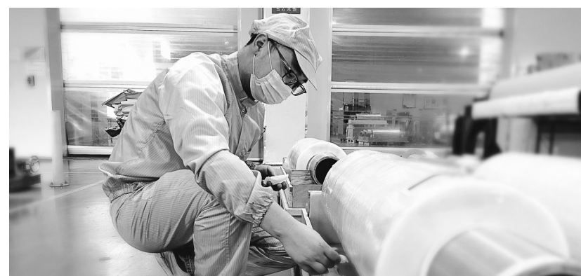
随着梅雨季节的到来,空气湿度也变大,给产品质量带来了很大的影响。对此,铜冠铜箔公司通过使铜箔尽量处于真空包装,保证车间恒温恒湿和添加干燥剂等一系列的措施来保障产品的干燥度,确保产品品质。图为该公司员工正在向产品包装箱里添加干燥剂。 吴 猛 摄
