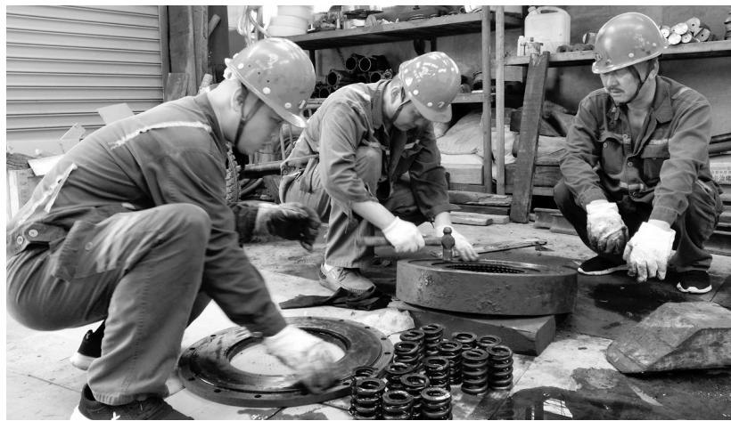
6月9日,铜山铜矿分公司维修人员在综合维修车间对铲运机制动器进行修复。据了解,该公司通过树立“节支就是增收、修旧就是降本”的意识,鼓励职工通过小发明、小创造、技术革新及合理化建议活动,实施设备修旧利废,确保实现材料、备件、设备效能最大化。刘少结 摄
