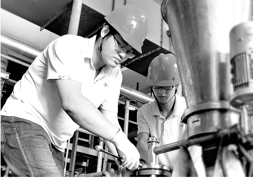
近日，铜冠铜箔公司五六工场溶铜工段对传统的人工添加活性炭的方法进行改造(如图)。改造后，不仅可以释放劳动力，还可以根据生产需求更加稳定地调节活性炭添加量。图为溶铜工段员工正在根据生产需求调节活性炭流速。 何 亮 吴 猛 摄
