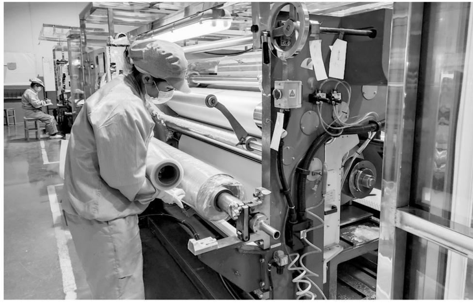
今年以来,铜冠铜箔公司结合管理提升年行动,加强内部管理,利用市场淡季提前进行设备检修维护工作,加大产品质量攻关力度,根据客户需求及时调整产品结构。5月份该公司5G通讯用RTF铜箔发货量突破历史记录,环比四月份增加45.4%。图为该公司分切员工正在对RTF铜箔进行下卷包装作业。
