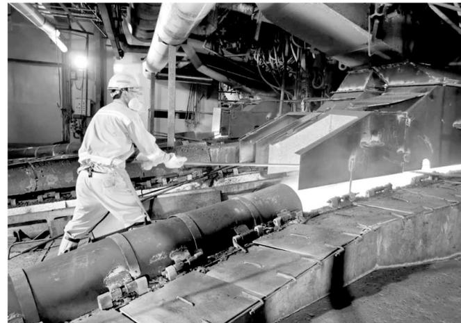
金冠铜业分公司双闪冶炼车间紧紧围绕管理提升年活动,以每周一问为契机,大力开展炉前管理行动,积极改进铜口和渣口闭环系统,持续加强炉前人员安全培训管理,积极推进班组5S和TPM活动。图为闪速熔炼炉渣口操作人员正在进行排渣作业。
