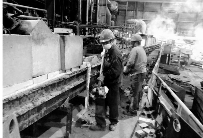
设备维修人员正在对金冠铜业公司阳极铜生产线上的出铜流槽进行维修前的拆解。该公司将出铜流槽的维护当成提高产量的重要因素,根据实际使用情况,及时对溜槽进行维修,确保阳极炉上下游工序流程通畅,无障碍衔接,促使生产高效运行。
