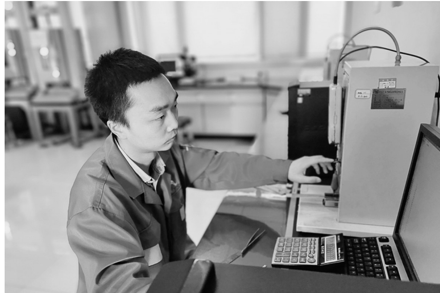
图为该公司研发人员正在对该公司最新研发的5G通讯用高频高速高性能电子铜箔,进行抗剥离试验。
