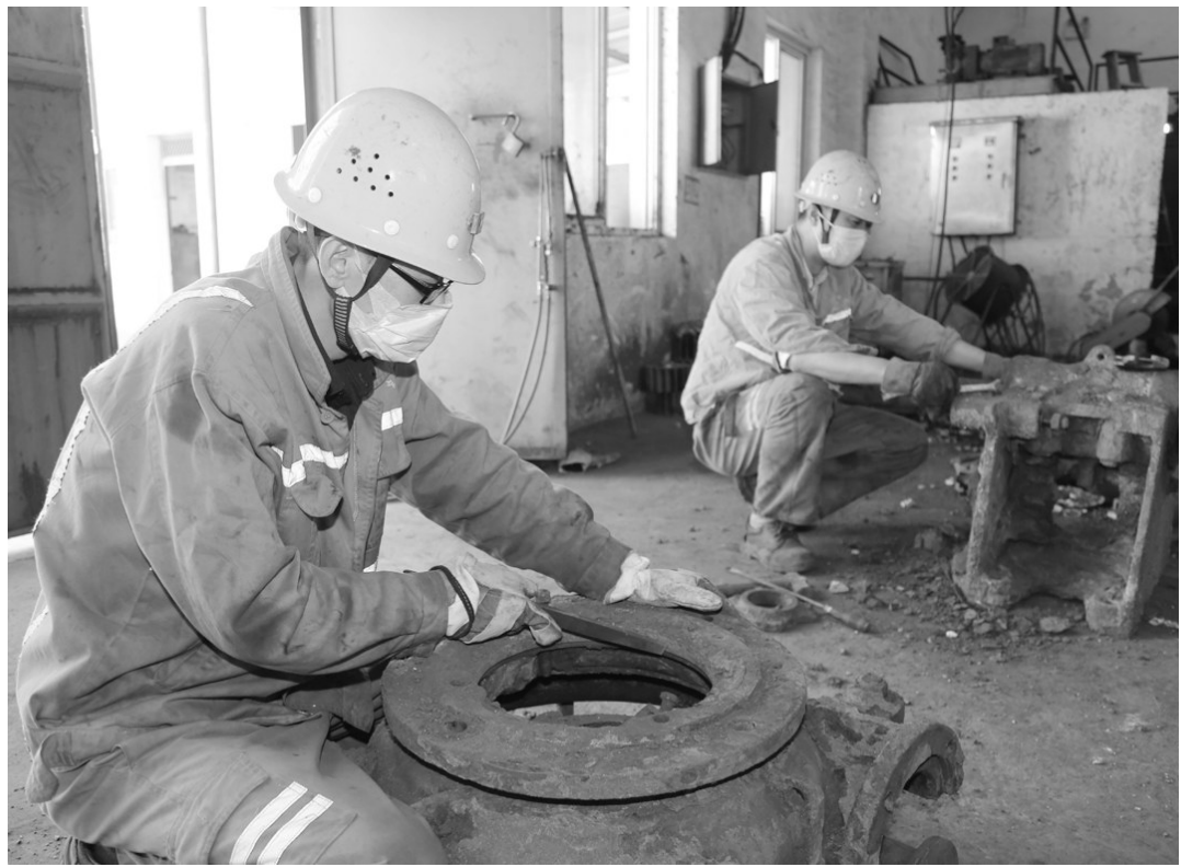
5月13日, 冬瓜山铜矿精矿车间职工正在维修渣浆泵。今年以来, 该车间充分发挥职工的聪明才智, 加大对设备的修旧利废和小改小革力度, 保障矿山正常生产, 也为企业降本增效工作起到积极的推动作用。1至4月份, 车间累计节约维修成本近7万元。
