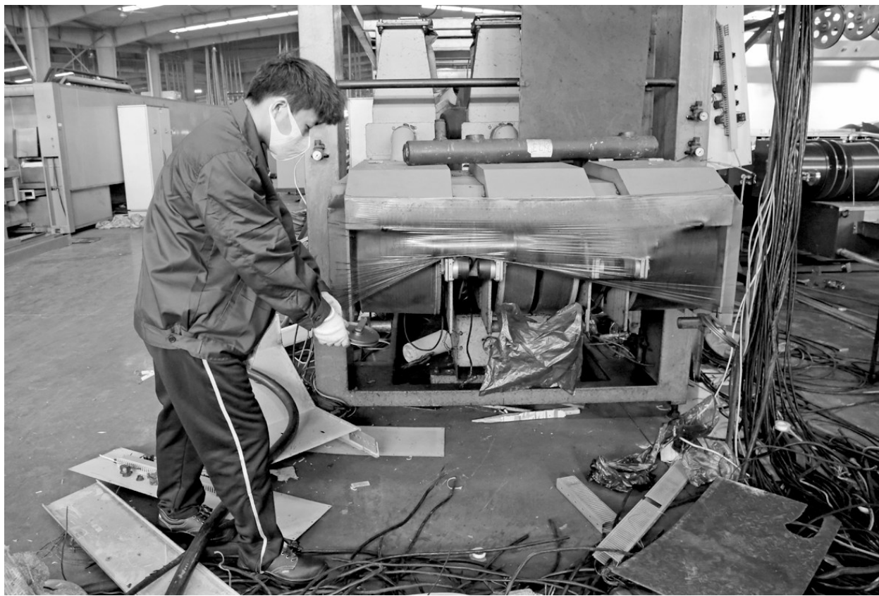
铜冠电工公司员工正在拆卸老旧漆包机。铜冠电工公司在深挖降耗中,积极加大老旧漆包机节能改造力度,通过改造使漆包线生产能耗下降了一半,生产效率提高20%,节能改造取得了良好效果。 王红平 华 伟 摄
