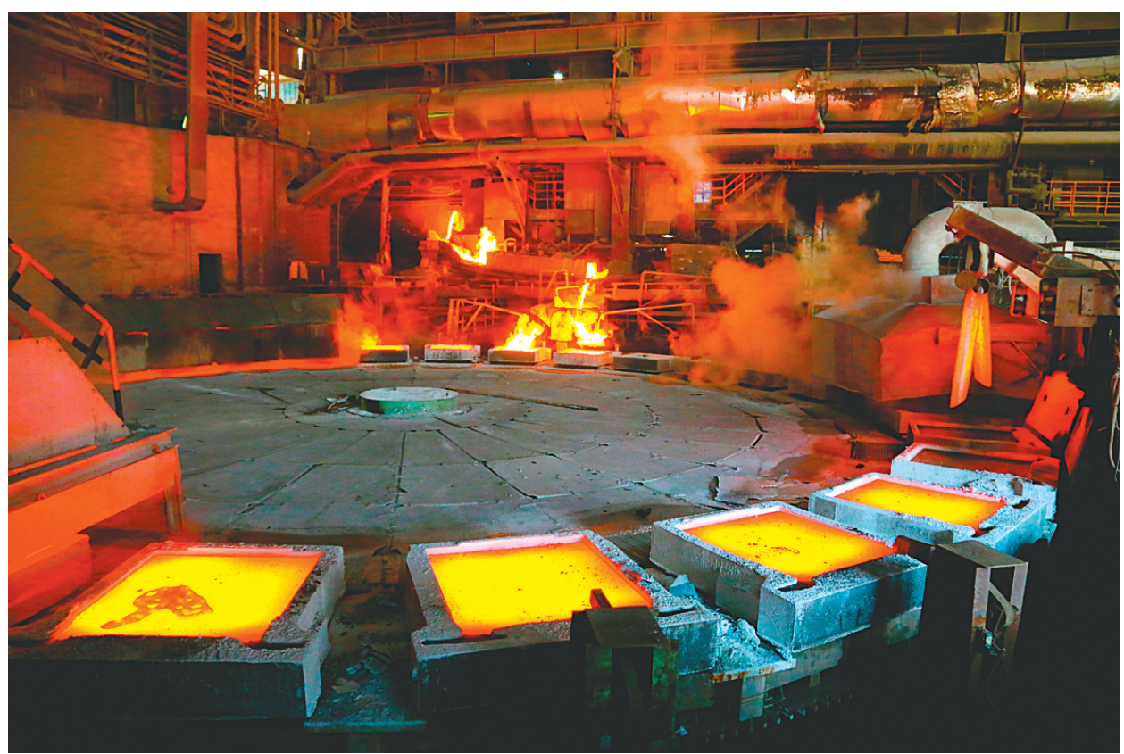
金隆铜业公司单圆盘浇铸正在如火如荼生产。该公司深挖各方潜力,加紧推进冶炼生产,力争夺回因疫情造成的各项损失。在关键的阳极板生产工序,该公司在确保双圆盘正常浇铸的同时,充分利用单圆盘的机动备用功能,实现不间断连续浇铸,确保铜阳极板产量平稳。复工复产以来,金隆铜业公司日均阳极板产量一千余吨。
