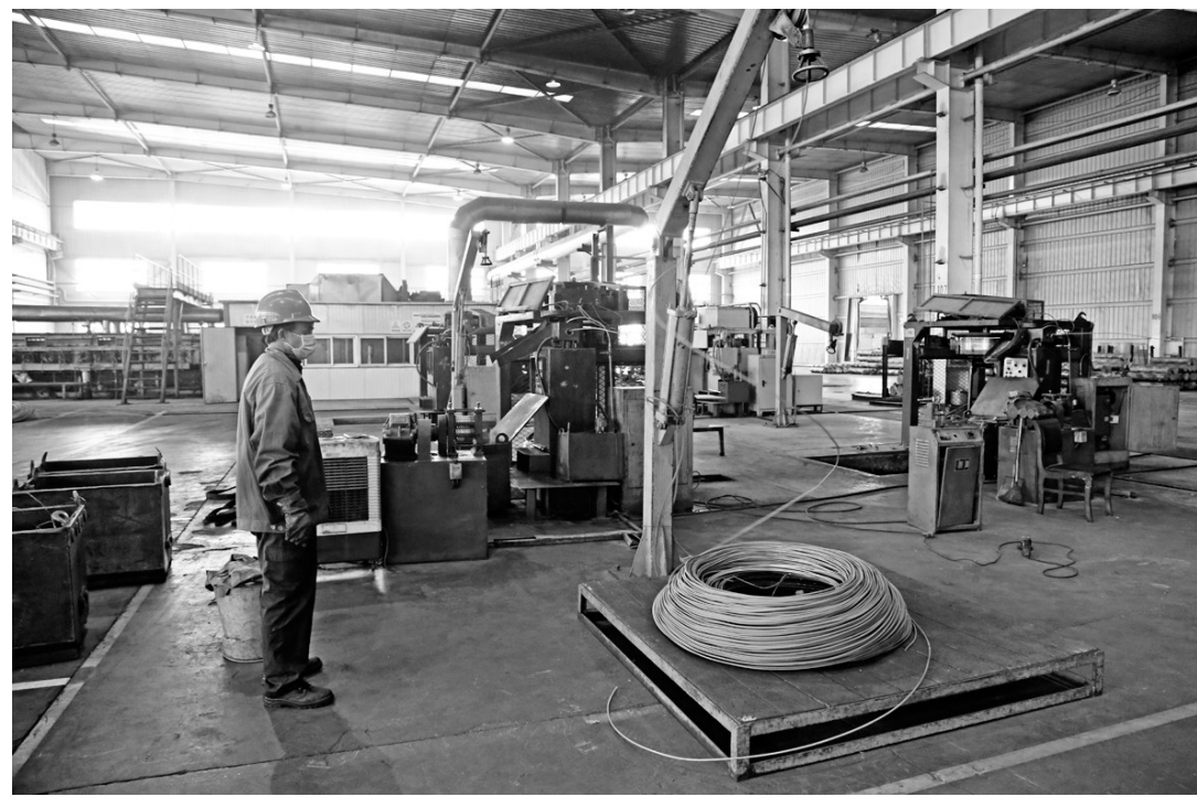
铜冠黄铜公司员工正在进行盘拉生产。铜冠黄铜公司在做精车削棒,做大红冲材的同时,积极做强盘卷料,以适合的规格发展盘卷料用户,提高产品整体销量。 王红平 汪勇 摄
