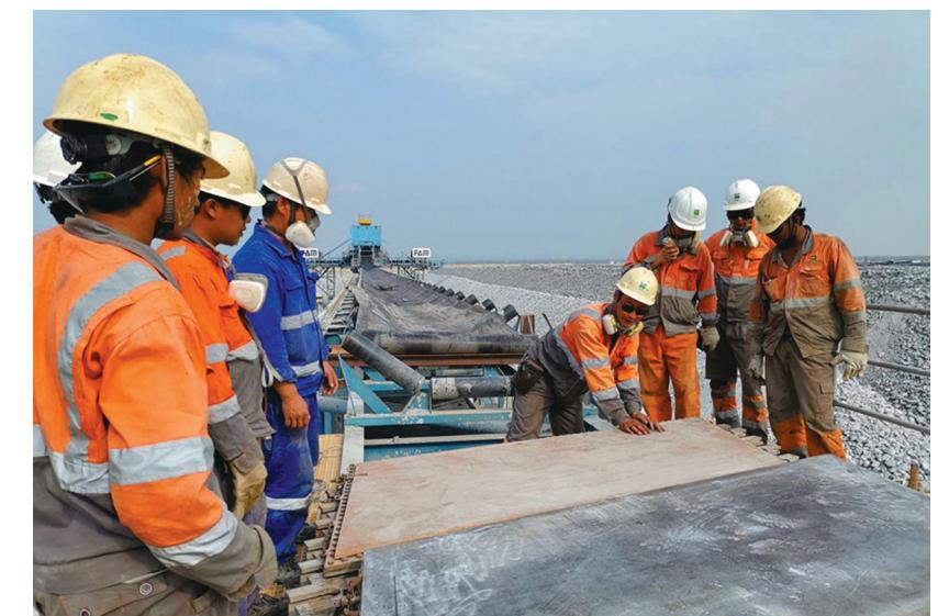
凤凰山矿业(缅甸)公司在日常工作中注重对缅甸员工的技能培训,做好传帮、带工作。图为中方人员指导缅甸员工用硫化胶接钢丝皮带。
