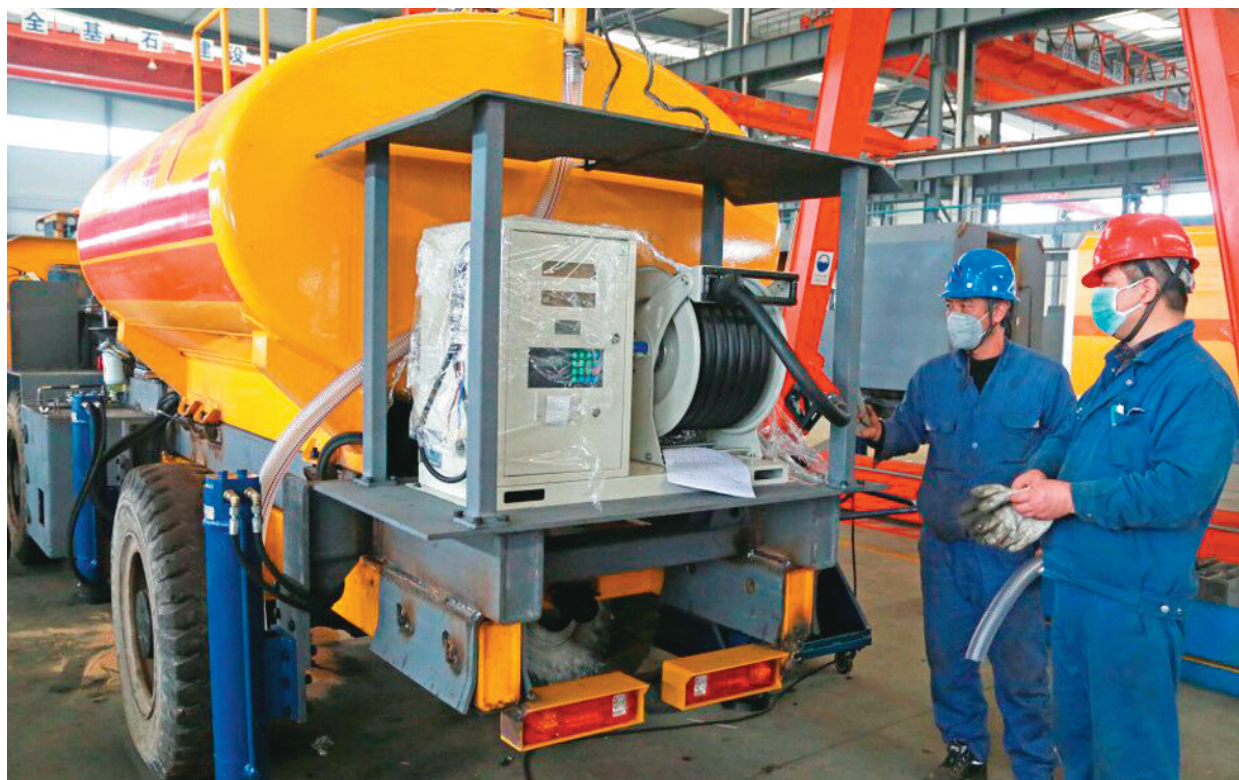
铜冠机械公司设备装配分厂员工正在组装多功能服务车。铜冠机械公司针对手的服务车、过滤器等一批急件订单,为将新冠肺炎疫情造成的工期影响降到最低,该公司复工后全力组织加工分厂、设备装配分厂等生产单位加紧制作和装配生产,努力保证客户需求。
