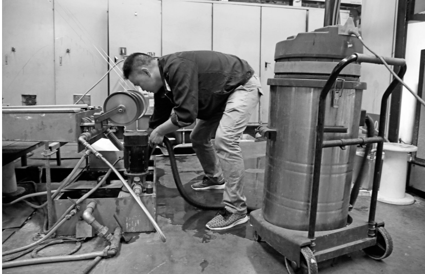
铜冠电工公司漆包线分厂员工正在清洗铜粉屑。铜冠电工公司漆包线分厂在漆包线生产过程中,通过及时对产生的铜粉屑进行清洗清理,为保障漆包线产品质量提供了清洁环境。
