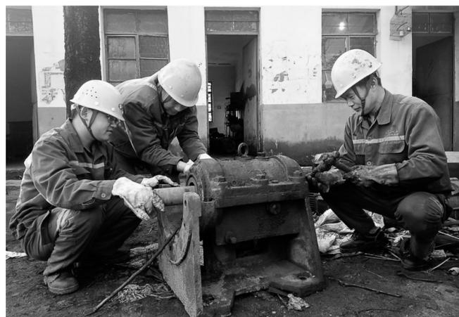
为提高青年员工的业务能力和专业技能，铜山铜矿分公司将以“老”带“新”作为促进青年员工成长成才的主抓手，为新入职青工精心挑选业务精湛、经验丰富、作风过硬的技术能手作为师傅，引领青工立足岗位，成长成才，为矿山发展建功立业。图为该分公司车间新员工李鑫在师傅指导下正确处理砂泵轴承的更换。
