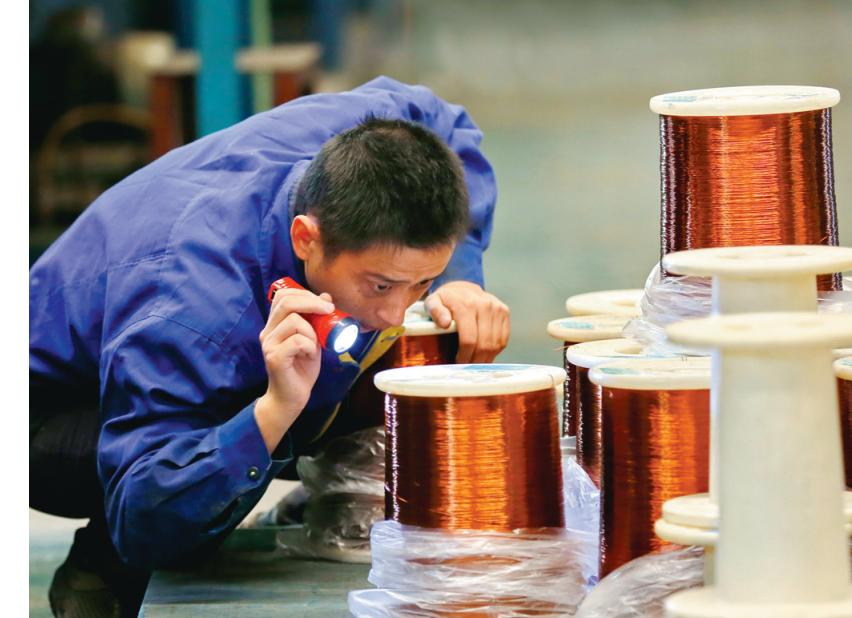
今年，铜冠电工公司进一步强化过程生产管理，严格监控产品工艺参数，涂漆配模、工艺卫生、在线粒子检测等重要环节，持续提升了漆包线成品质量，为企业推进高质量发展提供了保障。图为漆包线分厂检验人员正在认真检测成品漆外观质量情况。
