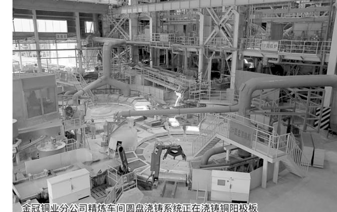
金冠铜业分公司精炼车间圆盘浇铸系统正在浇铸铜阳极板
