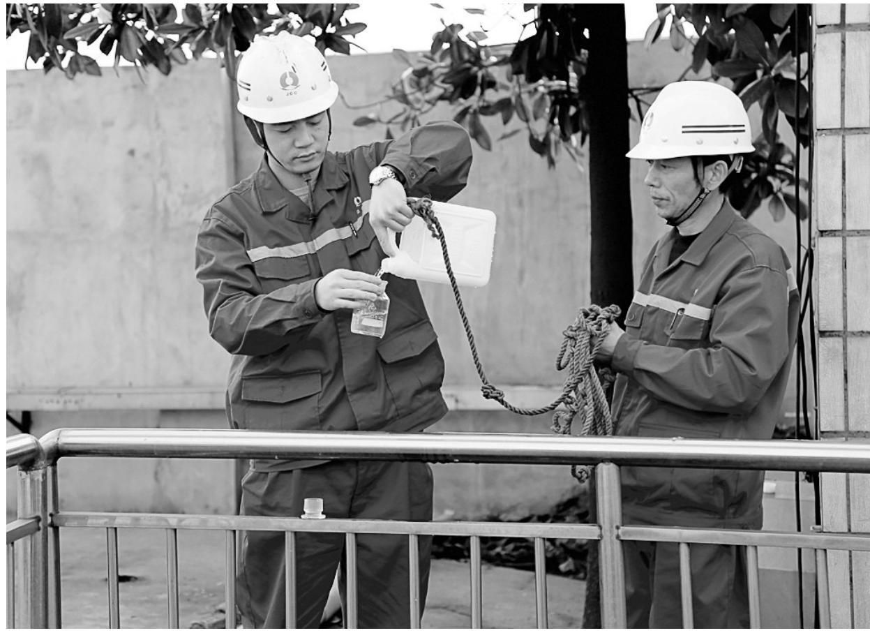
金隆铜业公司高度重视环保工作,把环保工作当成企业的生命线,严控生产流程,确保各工艺标准作业,同时加强对外排水、气的监控,确保全过程清洁生产。图为该公司人员正在总排口检测外排水水质。 章庆 摄
