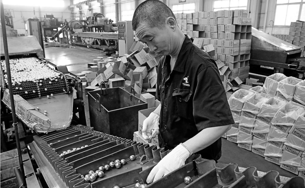
铜冠电工公司线材分公司员工正在分拣磷铜球。铜冠电工公司线材分公司通过加强生产过程控制,加大产品检验,稳定提高了产品质量。今年以来,磷铜产品成品率累计98.113%,与去年同期相比略有所上升,产品出厂合格率达到100%。 王红平 华 伟 摄
