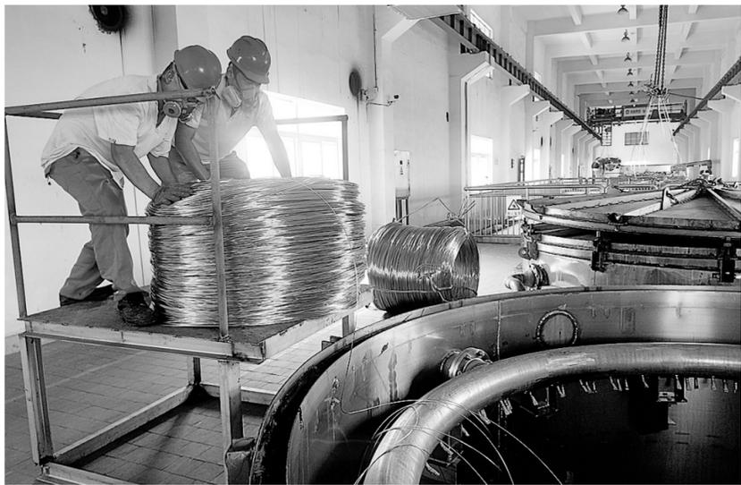
近日,秋老虎余威尚在,铜陵铜箔公司溶铜工段不畏高温,坚守岗位。自7月份以来,该工段采用人工布铜的方式进行投料,通过该方法,可以使铜料分布更加均匀,既提高了溶铜效率又节省了蒸汽消耗,为该公司加强节能减排管理,提高增收创效目标夯实了基础。
