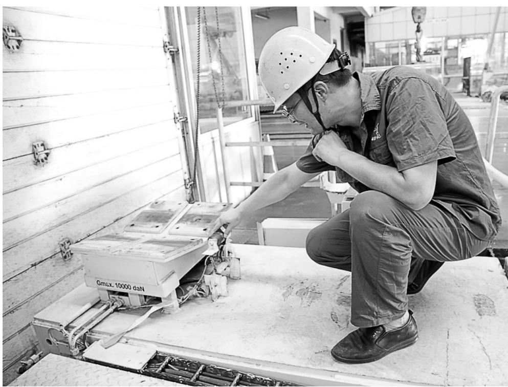
金威铜业分公司员工日前正在检查输送小车。金威铜业分公司针对板带生产中拉弯矫工序中上卷作业时存在的安全隐患，积极组织技术人员对输送小车安全设置进行技术改进，避免了作业风险。提高了安全性能。这项“输送小车的“安全设置”技术改进，日前获得了国家实用新型专利。
