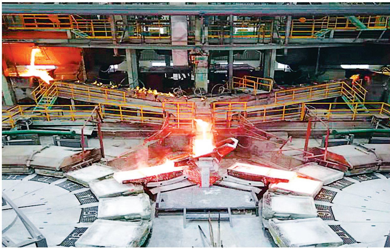
日前,随着奥炉精炼车间2号阳极炉火红的钢水通过中间包欢快地滴入圆盘浇铸成铜板(如图),标志着金冠铜业分公司奥炉首次年度大修结束后,一次性开车成功,铜酸生产系统工艺流程全线顺利贯通。 吴家富 周峰 摄
