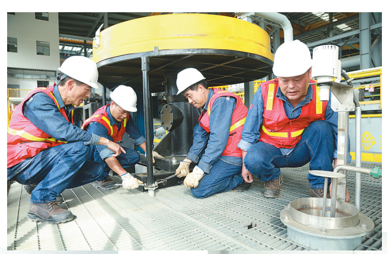
铜冠机械厄瓜多尔分公司员工在对浮选设备进行维护。
