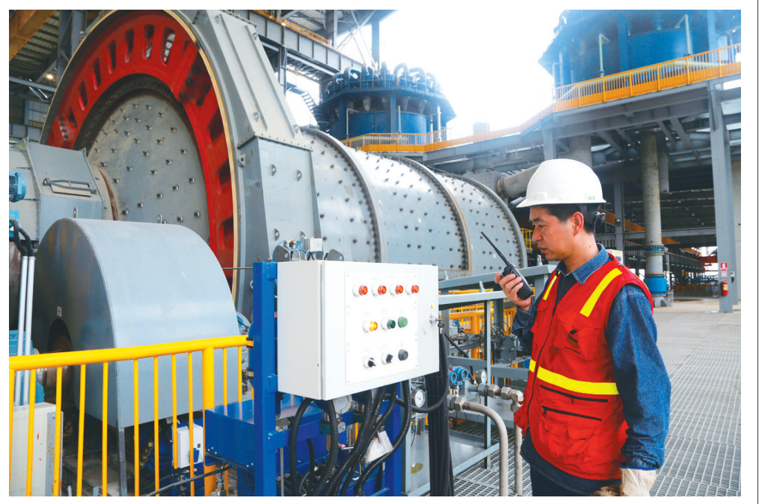
工程技术分公司海外项目部员工在进行球磨碎矿生产。
