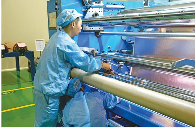
铜陵铜箔公司员工日前正在对分切设备进行校准。铜陵铜箔公司在开展好高端铜箔产品生产中,既重视员工的操作技能培训,又注重设备的保障。特别是在分切环节,这个公司员工定期对分切设备用百分表进行校准,确保了铜箔产品的均匀度和平整度。
