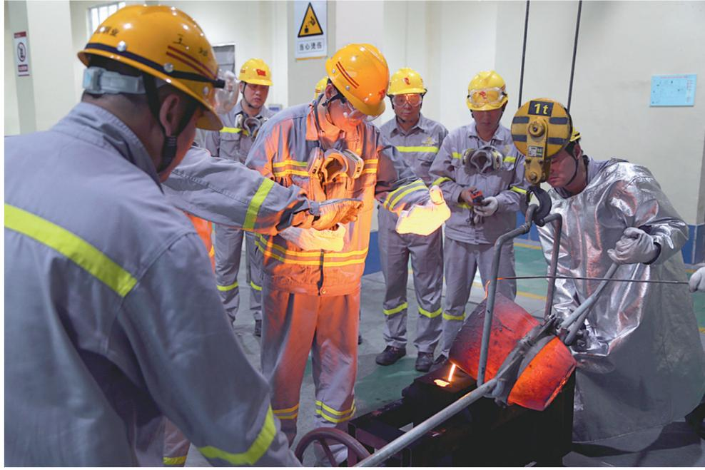
7月9日上午,金冠铜业分公司铜阳泥资源综合利用项目自5月8日进入带负荷试车以来,顺利产出第一批8块标准金锭。图为金冠铜业分公司稀贵车间精炼工序操作人员正在浇铸金锭。
