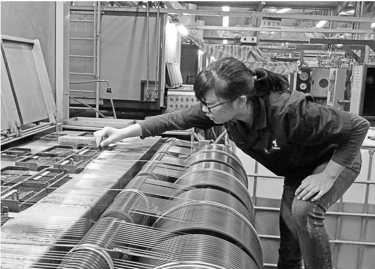
铜冠电工公司漆包线分厂员工正在对设备进行检查维护。铜冠电工公司面对今年更加严峻的环保形势和生产经营压力，通过不断完善生产工艺，优化系统操作参数，从设备的基础管理入手，在设备维护上下功夫，加强设备点巡检，实行日常点检与专业精益点检相结合，确保设备运转率，实现了稳产高产。
