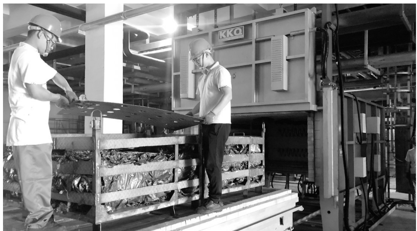
日前，铜陵铜箔公司引进一台全纤维回火炉，该回火炉通过废铜高温烧油处理将生产产生的废料转化为可以直接投入生产的原料，改变了之前废铜只能外售处理的方式，节省废铜折旧费的同时又提高了生产效率，为降低成本、制造优质铜箔保驾护航。
