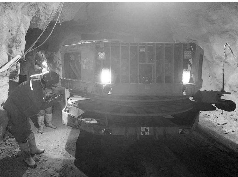
日前,铜冠(庐江)矿业公司采矿工区技术人员针对LH409E电铲卷缆盘运转不灵活易拉断电缆的问题,加装了手动润滑装置,经过试用,铲运机电缆拉断现象明显改善,电缆更换次数降低,节约生产成本几十万元。
