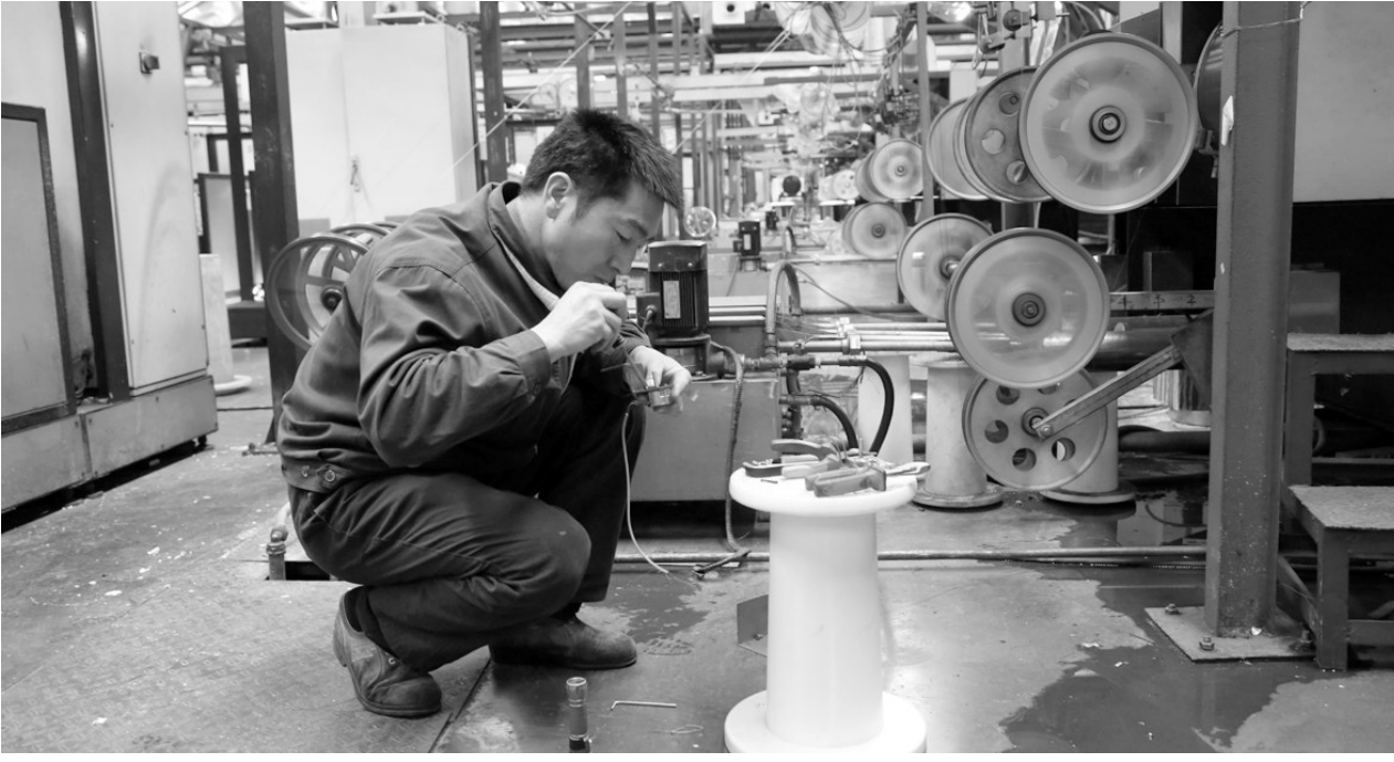
铜冠电工公司职工日前正在进行漆包机技术改造。今年以来,铜冠电工公司加大对漆包线生产过程中产生的废气治理,采用低温三次催化燃烧吸附技术处理漆包线尾气,保证了废气在漆包机烘炉内燃烧更充分。并通过漆包机环保节能改造,使产品单位能耗下降三分之二,挥发性有机化合物下降50%以上。该项技术的应用走在国内漆包线行业前列,处理后废气排放量低于国家标准。 王红平 华伟 摄
