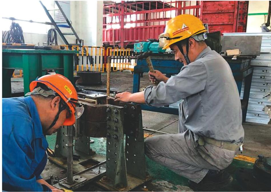
近日,金冠铜业分公司保全车间点检人员在维修间对前期更换下的净液短路器的轴承及轴承夹板、灭弧套、弹簧套和绝缘块等进行自主更换维修,并对此设备其他部件及软连接部分进行了清理维护。肖华兵 摄
