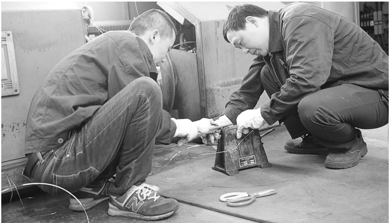
铜冠电工公司职工日前正在拉丝生产中接线作业。铜冠电工公司漆包线分厂拉丝机组保持正常运行生产的拉丝机有3台大拉机、2台中拉机。在保证正常生产的情况下,漆包线分厂通过合理调节生产时间,在拉丝机组实施调荷避峰,仅此一项,每年可节约电费约140万元。
