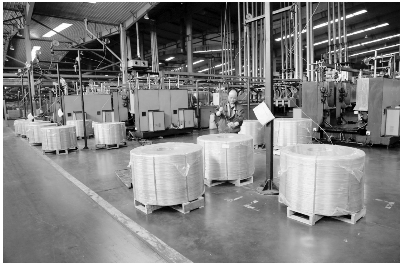
铜冠电工公司漆包线分厂职工日前正在进行漆包铝线生产。铜冠电工公司今年以来加大了将闲置漆包机改造用于漆包铝线生产的步伐,在去年改造投产2台漆包机的基础上,今年又成功改造了2台,使目前漆包铝线生产线达到了4条,铝线月产量达到了76吨。
