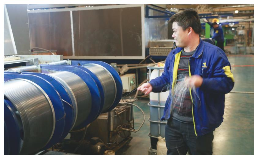
铜冠电工公司漆包线分厂职工日前正在铝线试制作业。铜冠电工公司针对市场需求变化,积极尝试将老厂搬迁过来闲置的漆包机改造成漆包铝线生产设备,并于去年成功改造了2套生产线,这也为这个公司提出3000吨铝线项目提供了可行性依据。随着日前这个公司3000吨铝线项目通过专家评审,下一步这个公司将加大漆包铝线生产设备的改造力度。
