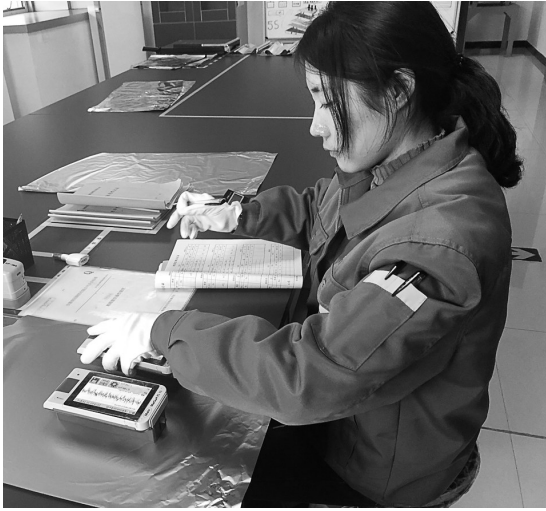
新年以来，铜陵铜箔公司加大对铜箔样品的检测力度，将检测数据汇总统计，找出其规律性，车间根据检测结果对关键工序进行重点操纵，从而对产品进行不断优化。通过此举预防了不合格的产品，消除了不良隐患，为开拓市场提供了有利的保障。图为该公司员工对铜箔样品进行检测。
