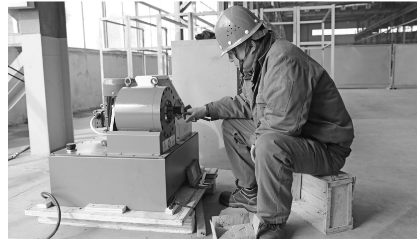
铜冠机械公司无轨分厂职工日前正在加工油管。该公司无轨设备上使用的油管过去是从外部采购且成本高，无轨分厂积极引进扣管设备，自行加工成品油管，用以替代外部采购，较好地降低了油管成本费用。
