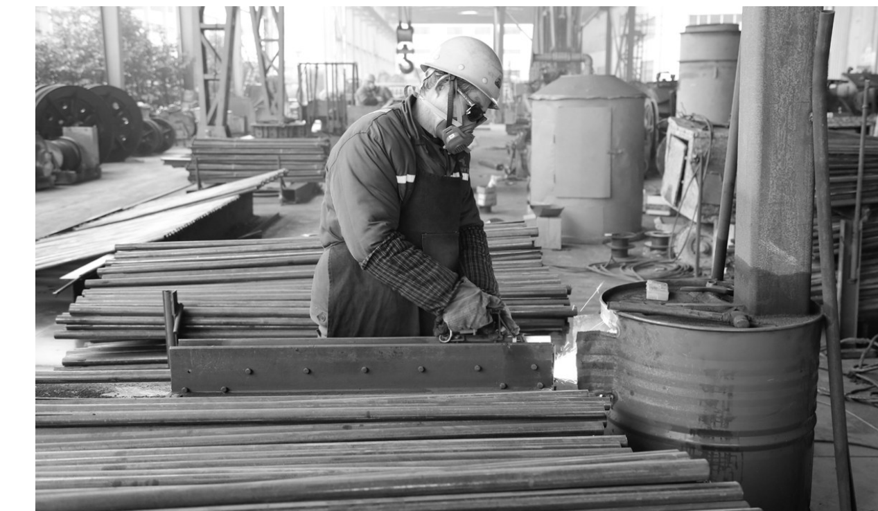
铜冠矿建公司机修分公司职工日前正在制作锚杆。该分公司自主研发生产并获得国家专利的胀管锚杆,不仅满足了矿建生产需要,还大大提高了使用效果。2018年,该分公司生产胀管锚杆达134000根,同比增加了28000根。
